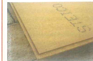
Détail du panneau Steico. Épaisseur : 4,2 cm
